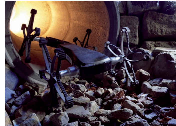
ASGUARD ist ein mobiles Robotersystem, das zur Erkundung und Sicherung von großen Außengeländen oder Industrieanlagen eingesetzt werden kann. ©DFKI
